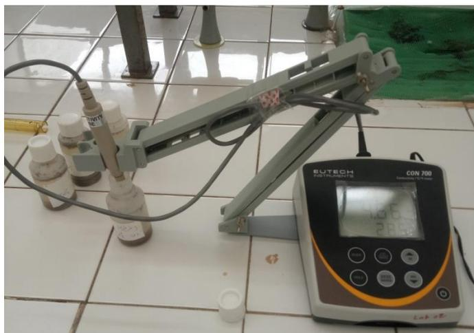
الصورة (5) : عملية القياس بجهاز conductivité mètre
